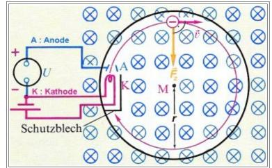
Nein, denn Plattenkondensatoren lenken konstant in Richtung einer Platte ab. Für eine Kreisbahn muss sich die Richtung der Ablenkung immer ändern und ständig zum Mittelpunkt der Kreisbahn zeigen.
