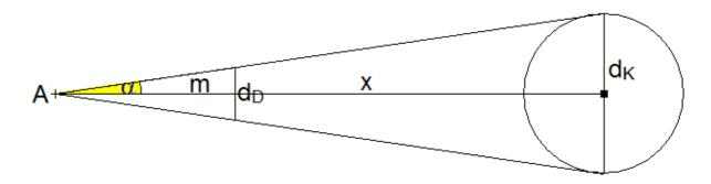
x ist die Entfernung vom Auge bis zum Mittelpunkt der Kugel. Dann gilt mit dem Strahlensatz:
